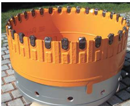
Стартовый башмак обсадных труб со сменными накладками - полосами и пластинами Casing shoe with wear strips and wear plates
