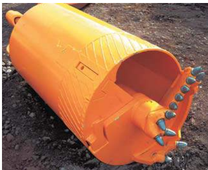
Ковшебуры с нанесенной наплавкой Bucket with hard facing
