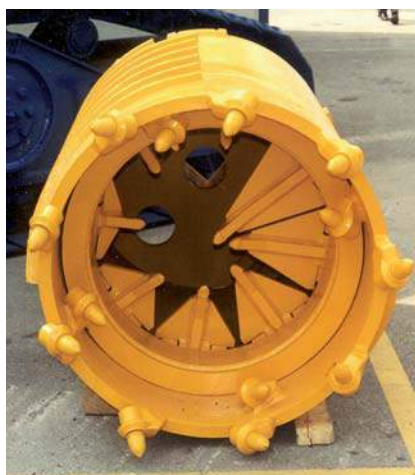
Колонковый бур с керноуловителем Core barrel with core catcher
