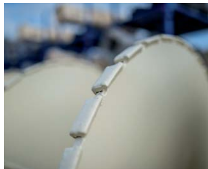
Сменные накладки Angular wear strips
